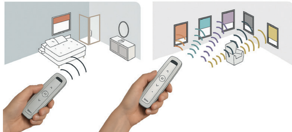
Commande monocanal : commande individuellement un store à enrouleur motorisé
