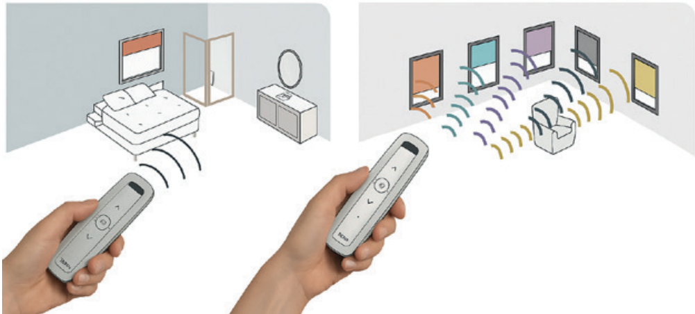
Eenkanaals bediening: stuurt een gemotoriseerd rolgordijn individueel
