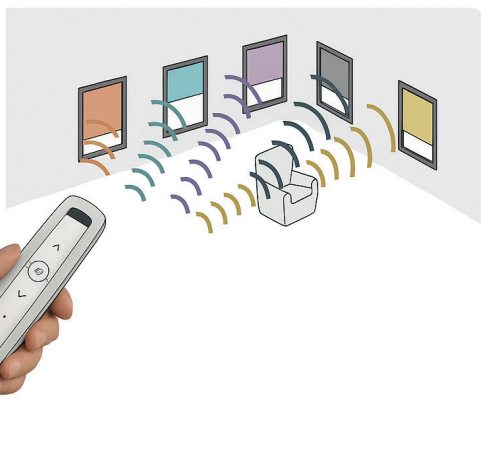
Meerkanaals bediening: bedien 1 tot 5 elektrische rolgordijnen individueel of als groep (max 16 kanalen met individuele bediening)
